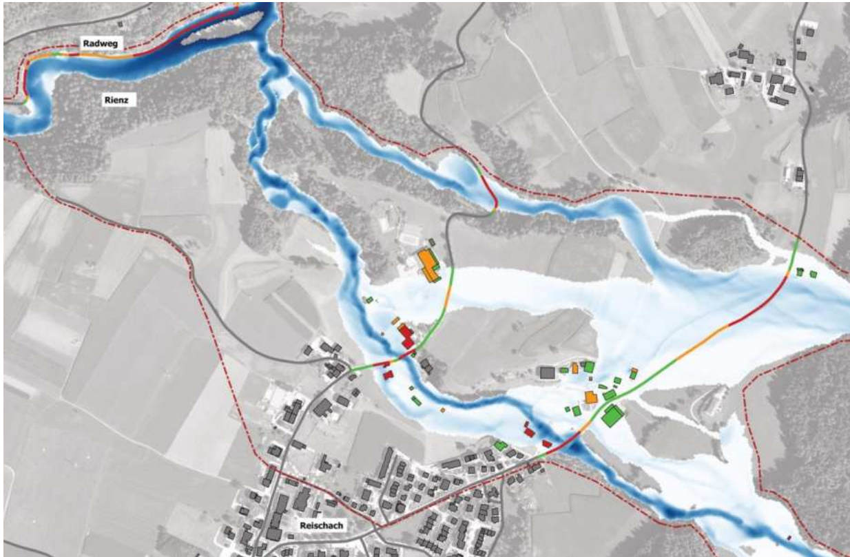
Bild 2: Gefährdete Gebäude und Infrastrukturen – Bereich „Reischach“
