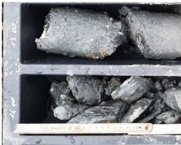
Foto 18: Bohrkern aus kataklastischen Graphitschiefern (Erkundungsbohrung S4).
