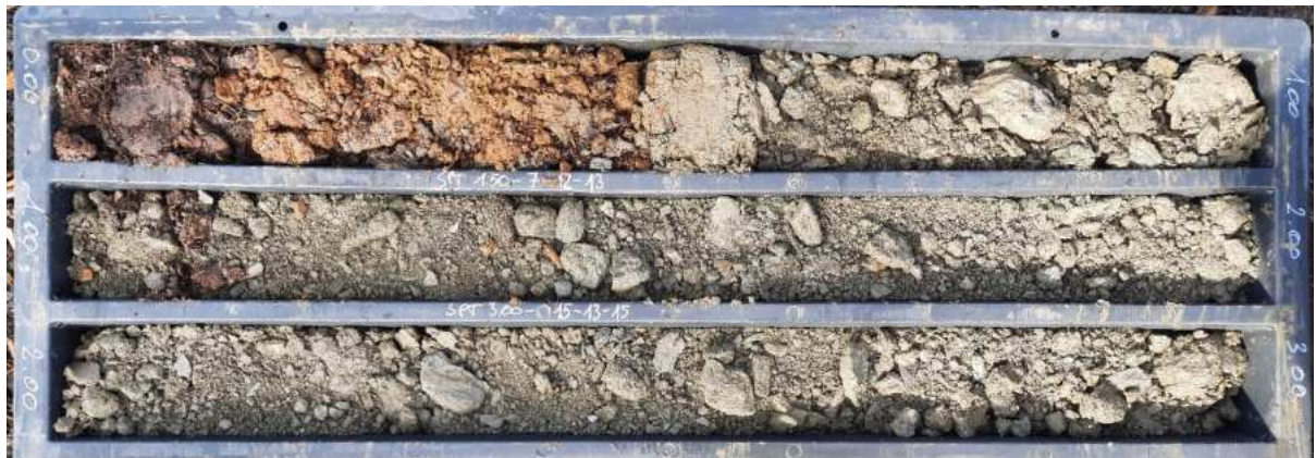
Foto 13: Hang- und Verwitterungsschutt in der Erkundungsbohrung S1 zwischen 0,5 und 3 m Tiefe.
