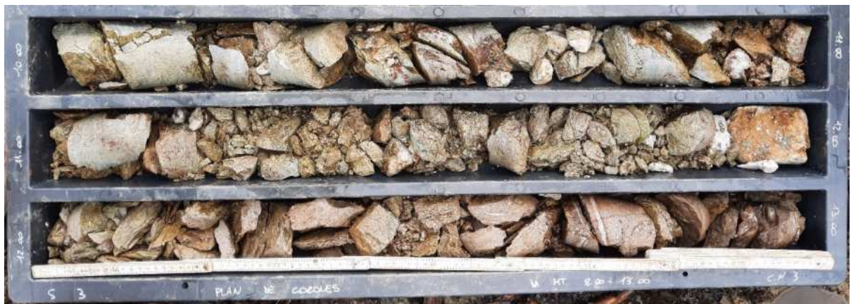
Foto 16: Quarzphyllit mit kataklastischem Gefüge in der Erkundungsbohrung S3 zwischen 10 und 13 m Tiefe.
