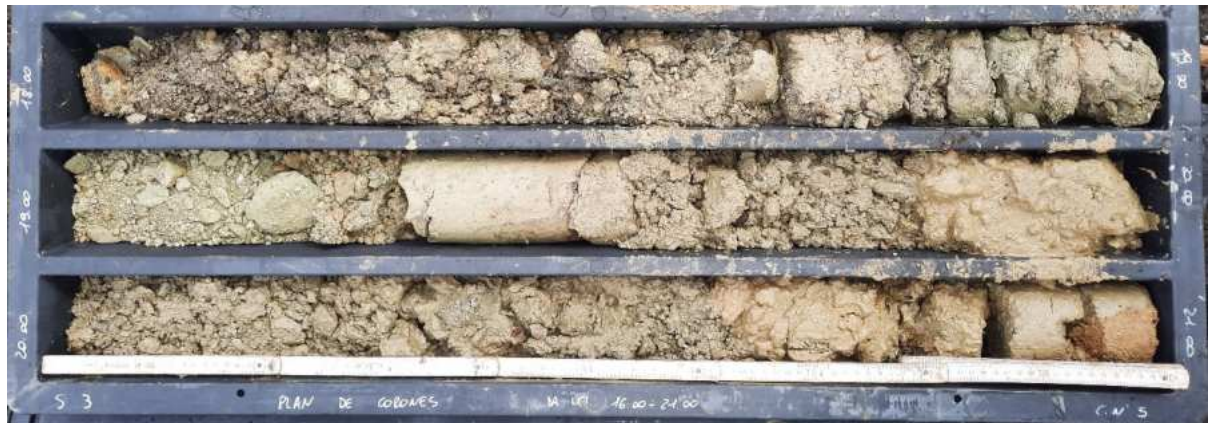
Foto 17: Quarzphyllit mit kakiritischem Gefüge in der Erkundungsbohrung S3 zwischen 18 und 20 m Tiefe.
